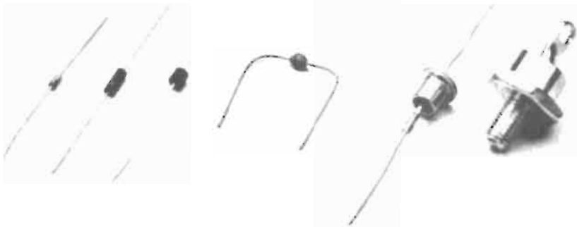
Fig. 3 - I diodi a semiconduttore, per deboli segnali, raddrizzatori, Zeners ecc. si presentano così.
